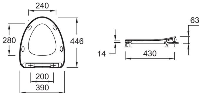
Спецификация продукта: Тонкое сиденье термодюропласт. E20069. Коллекция: NOUVELLE VAGUE. ВЕС: 2,9 кг. МАТЕРИАЛ: Термодюр. ТИП КРЫШКИ-СИДЕНЬЯ: Съёмная с механизмом "плавное опускание". МАТЕРИАЛ СИДЕНЬЯ: Термодюр. ШАРНИРЫ: Металл. ГАРАНТИЯ НА КРЫШКУ-СИДЕНЬЕ: 2 года. УПАКОВКА: Единая упаковка.
